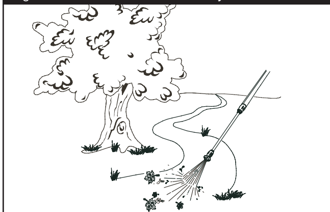
Figure 26 — Vérification de la Forme de Jet
